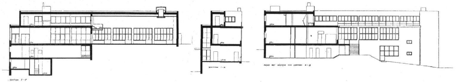
ABB. 2 BIS 5 / STUDENTENHAUS IN STOCKHOLM / ARCHITEKTEN: SVEN MARKELIUS UND UNO AHREN, STOCKHOLM / SCHNITTE 1:500 LINKS LÄNGSSCHNITT DURCH SAAL UND TAGESHEIM, MITTE QUERSCHNITT DURCH GARDEROBE UND BIBLIOTHEK, RECHTS QUERSCHNITT MIT ANSICHT DES VERSAMMLUNGSRAUMES UND DER BIBLIOTHEK, UNTEN QUERSCHNITT DURCH DEN SAAL
