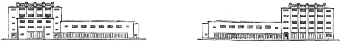
Abb. 29 / Schaltwerk Ebersstraße / Architekt: Richard Brademann, Berlin Links das Hochspannungshaus, rechts das Gleichrichterhaus mit der Schaltwarte, deren Oberlicht zwischen den Entlüfterköpfen sichtbar ist.
