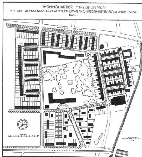
Abb. 2—8 | Basel | Wohnquartier Hirsbrunnen | Architekt: Hans Bernoulli und August Künzle, Zürich | Blick in das Innere eines Baublockes | Lageplan der Siedlung | Grundrisse und Ansichten der Baublocke sowie Schnitt (nur die Hälfte) durch eine Straße
