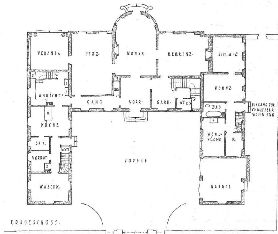
Abb. 14 | Wohnhaus W. in Leipzig-Raschwitz | Architekt: Paul Schultze-Naumburg Erdgeschoß-Grundriß 1:300 Vgl. Abb. 10 und 11 bis 13
