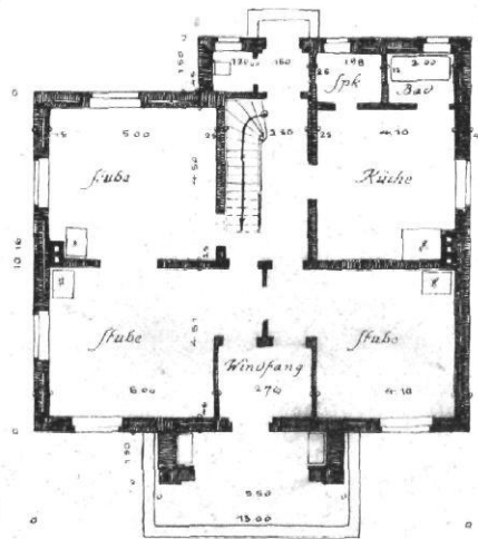
Grundriß des Erdgeschosses M 1 : 250
